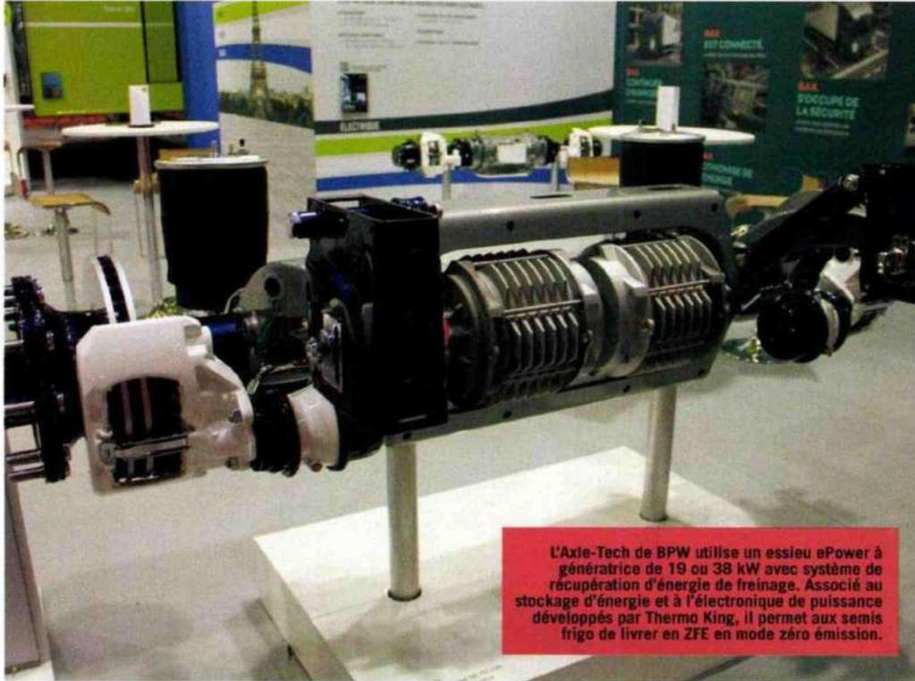
L'Axle-Tech de BPW utilise un essieu ePower à génératrice de 19 ou 38 kW avec système de récupération d'énergie de freinage. Associé au stockage d'énergie et à l'électronique de puissance développés par Thermo King, il permet aux semis frigo de livrer en ZFE en mode zéro émission.
